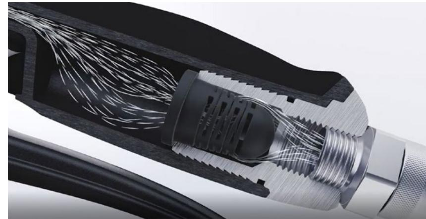
Dosierhebel betätigt - Druckluft strömt durch die Pro One (2).
